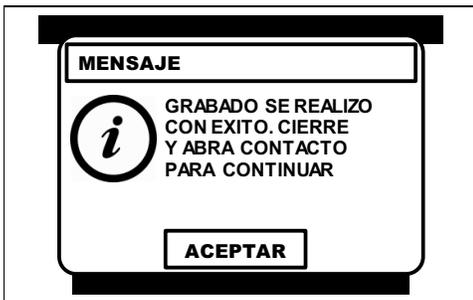
En ese momento el CJ BT mostrara un **mensaje de confirmación**, donde indica la modificación correcta del **VIN** y solicita que se coloque el conmutador de encendido en la posición de **OFF** y posteriormente en la posición de **ON**.
