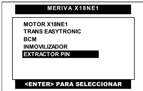
Pulse en la pantalla del CJ BT la opción de **EXTRACTOR PIN** o selecciónela por medio de las teclas <ARRIBA> o <ABAJO> y presione la tecla <ENTER>.
