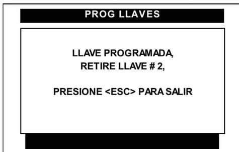
En ese momento, la **llave # 2** está **programada**, retire la llave del conmutador de encendido y presione la tecla <ESC> para salir.
