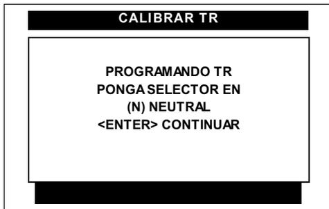
Coloque la palanca en la posición de **NEUTRAL** y presione la tecla **<ENTER>** para que aprenda la posición.
