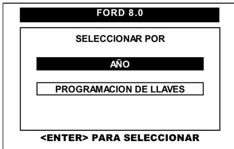
Pulse en la pantalla del CJ BT la opción **AÑO** o selecciónela por medio de las teclas <ARRIBA> o <ABAJO> seleccione el programa deseado y presione la tecla <ENTER>.
