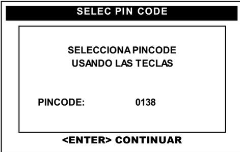
Introduzca el PIN CODE al CJ BT, utilizando las flechas <ARRIBA> o <ABAJO> para **modificar el valor del dígito** y con las flechas <IZQUIERDA> y <DERECHA> para seleccionar el **dígito a modificar**.
