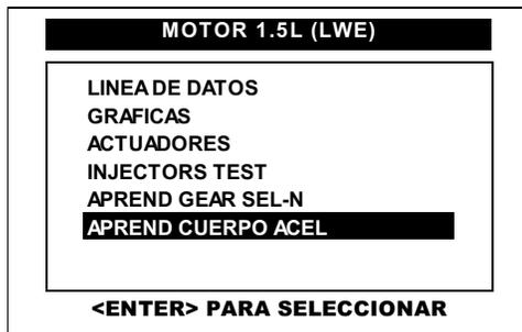
Del menú principal del sistema de motor, con el motor apagado y el conmutador de encendido en la posición de ON (**KOEO**), pulse en la pantalla del CJ BT la opción **APREND CUERPO ACEL** o selecciónela por medio de las teclas <ARRIBA> o <ABAJO> y presione la tecla <ENTER>.
