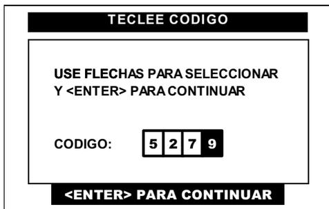
Para introducir el código PIN, utilice las flechas <ARRIBA> o <ABAJO> para **modificar el valor del dígito** y con las flechas <IZQUIERDA> y <DERECHA> seleccione el **dígito a modificar**.
