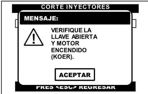
Al seleccionar el inyector a probar, el CJ BT despliega una advertencia, donde se indica que la prueba se debe de realizar con el conmutador de encendido en la posición de **ON** y el motor **encendido (KOER)**.
