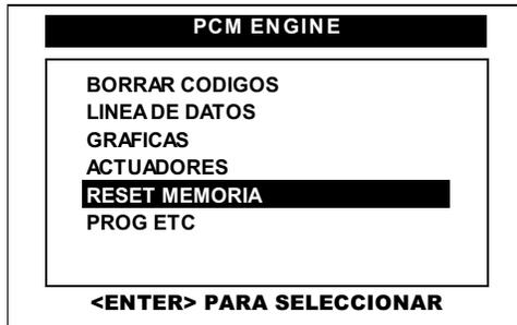
Del menú principal del sistema de **PCM** o **MOTOR** y con el conmutador de encendido en la posición de **ON** y el motor apagado (KOEO) pulse en la pantalla del CJ BT la opción **RESET MEMORIA** o selecciónela por medio de las teclas <ARRIBA> o <ABAJO> y presione la tecla <ENTER>.
