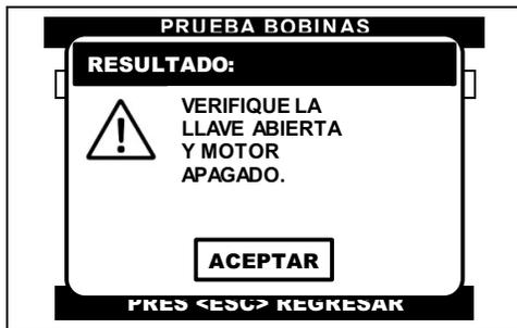
Al seleccionar la **bobina** a probar, el CJ BT despliega una advertencia, donde se indica que la prueba solo se puede realizar con el conmutador de encendido en la posición de **ON** y el **motor apagado (KOEO)**.
