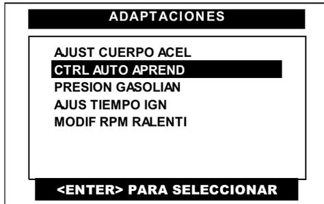
Pulse en la pantalla del CJ BT la opción **CTRL AUTO APREND** o selecciónela por medio de las teclas <ARRIBA> o <ABAJO> y presione la tecla <ENTER>.
