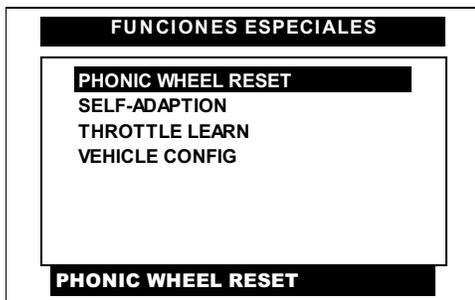
Del menú de **FUNCIONES ESPECIALES**, pulse en la pantalla del CJ BT la opción de **PHONIC WHEEL RESET** o selecciónela por medio de las teclas <ARRIBA> o <ABAJO> y presione la tecla <ENTER>.
