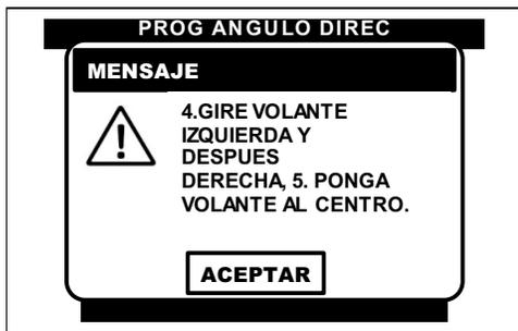
✓ Gire el volante hasta el tope hacia la izquierda y después hacia la derecha.
