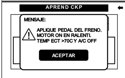
Encienda el motor del auto, la **temperatura del motor** tiene que ser superior a los **70 °C** y el **aire acondicionado** debe de estar **apagado**.
