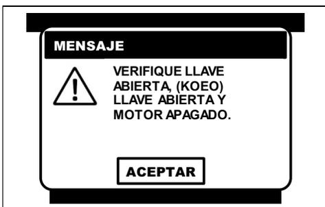
Al seleccionar la función de **ACTUADORES**, el CJ BT despliega una advertencia, donde se indica que la prueba solo se puede realizar con el conmutador de encendido en la posición de ON y el motor apagado (**KOEO**).
