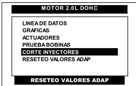
Del menú principal del sistema de motor pulse en la pantalla del CJ BT la opción **CORTE INYECTORES** o selecciónela por medio de las teclas <ARRIBA> o <ABAJO> y presione la tecla <ENTER>.
