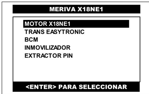
Pulse en la pantalla del CJ BT el **SISTEMA** a diagnosticar o selecciónelo por medio de las teclas <ARRIBA> o <ABAJO> y presione la tecla <ENTER>.
