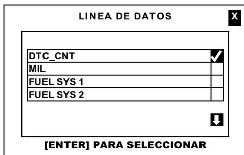
Para crear una **lista** de la **información** requerida, seleccione el **parámetro** requerido pulsándolo o utilizando las teclas <ARRIBA> o <ABAJO> y presionando la tecla <ENTER> para incluirlo en la lista.
