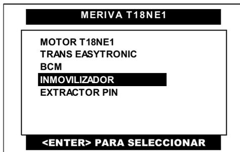
Pulse en la pantalla del CJ BT la opción de **INMOVILIZADOR** o selecciónela por medio de las teclas <ARRIBA> o <ABAJO> y presione la tecla <ENTER>.
