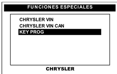
Pulse en la pantalla del CJ BT el programa **KEY PROG** o selecciónelo por medio de las teclas <ARRIBA> o <ABAJO> y presione la tecla <ENTER>.
