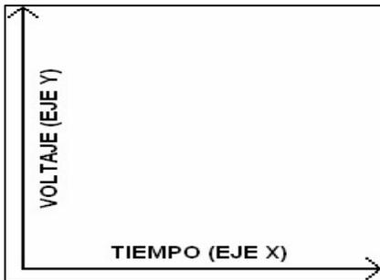
A grandes rasgos, el funcionamiento del osciloscopio es muy sencillo, este grafica el comportamiento de voltaje en relación con el tiempo.
