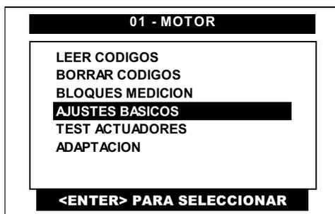
Pulse en la pantalla del CJ BT la opción de **AJUSTES BASICOS** o selecciónela por medio de las teclas <ARRIBA> o <ABAJO> y presione la tecla <ENTER>.
