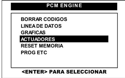
Pulse en la pantalla del CJ BT la opción **ACTUADORES** o selecciónela por medio de las teclas <ARRIBA> o <ABAJO> y presione la tecla <ENTER>.
