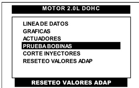
Del menú principal del sistema de motor pulse en la pantalla del CJ BT la opción **PRUEBA BOBINAS** o selecciónela por medio de las teclas <ARRIBA> o <ABAJO> y presione la tecla <ENTER>.
