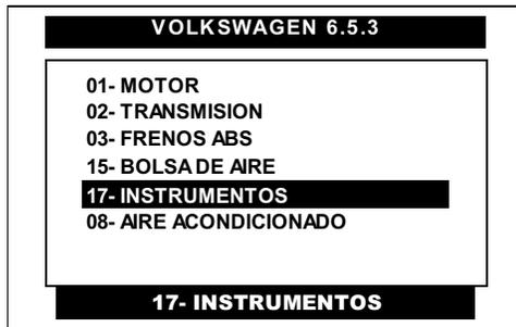
Pulse en la pantalla del CJ BT el sistema de **INSTRUMENTOS** o **INMOVILIZADOR** (según el sistema con el que cuente el vehículo) o selecciónelo por medio de las teclas <ARRIBA> o <ABAJO> y presione la tecla <ENTER>.
