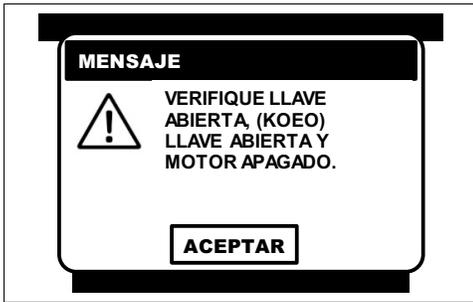
Al seleccionar cualquiera de las **FUNCIONES ESPECIALES**, el CJ BT despliega un mensaje, donde se indica que la prueba solo se puede realizar con el conmutador de encendido en la posición de ON y el motor apagado (**KOEO**).
