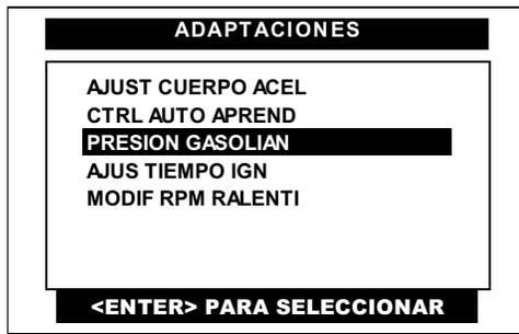
Pulse en la pantalla del CJ BT la opción **PRESION GASOLINA** o selecciónela por medio de las teclas <ARRIBA> o <ABAJO> y presione la tecla <ENTER>.
