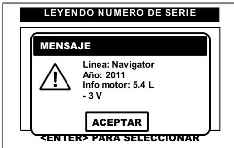
En el momento en el que el CJ BT **decodifica** el número de **VIN**, despliega en la pantalla la información. Pulse en la pantalla del CJ BT la opción de **<ACEPTAR>** o presione la tecla **<ENTER>** para continuar.
