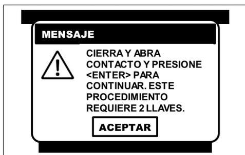
En ese momento el **CJ BT** solicita colocar el conmutador de encendido en la posición de **OFF** y posteriormente en la posición de **ON**, también nos recuerda que necesitamos **mínimo 2** llaves para realizar cualquier procedimiento.
