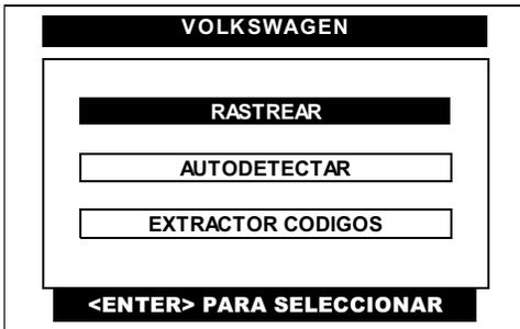
Pulse en la pantalla del CJ BT la opción de **RASTREAR** o selecciónela por medio de las teclas <ARRIBA> o <ABAJO> y presione la tecla <ENTER>.
