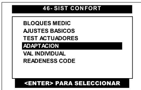
Pulse en la pantalla del CJ BT la opción de **ADAPTACION** o selecciónela por medio de las teclas <ARRIBA> o <ABAJO> y presione la tecla <ENTER>.
