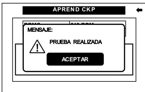
En cuanto se alcance el corte de revoluciones, el CJ BT desplegará una pantalla donde confirma que la prueba fue realizada correctamente.
