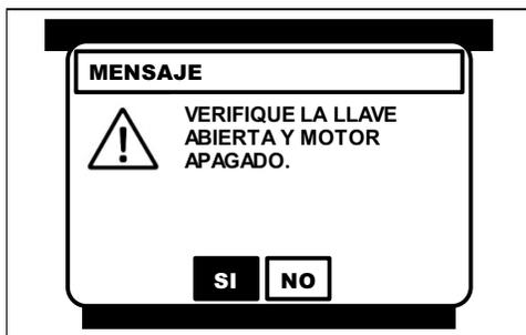
Verifique que el conmutador de encendido se encuentre en la posición de **ON** y el motor se encuentre apagado (**KOEO**).
