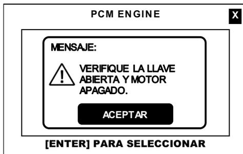
Al seleccionar la función de **RESET MEMORIA**, el CJ BT despliega una advertencia, donde se indica que la prueba solo se puede realizar con el conmutador de encendido en la posición de ON y el motor apagado (**KOEO**).
