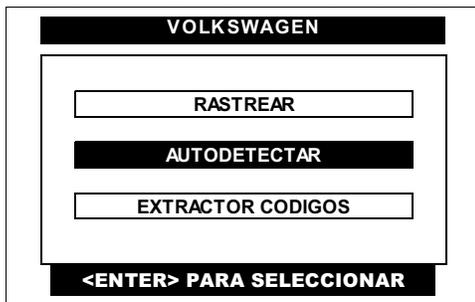
Pulse en la pantalla del CJ BT la opción de **AUTODETECTAR** o selecciónela por medio de las teclas <ARRIBA> o <ABAJO> y presione la tecla <ENTER>.
