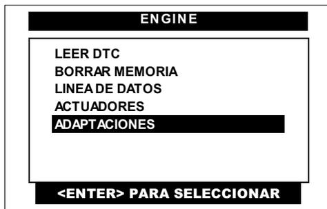
Pulse en la pantalla del CJ BT la opción **ADAPTACIONES** o selecciónela por medio de las teclas <ARRIBA> o <ABAJO> y presione la tecla <ENTER>.
