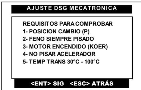
De igual manera, el CJ BT despliega las condiciones en las que se debe de hacer este ajuste.
