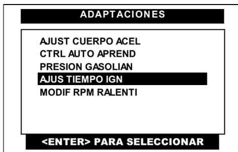
Pulse en la pantalla del CJ BT la opción **AJUS TIEMPO IGN** o selecciónela por medio de las teclas <ARRIBA> o <ABAJO> y presione la tecla <ENTER>.
