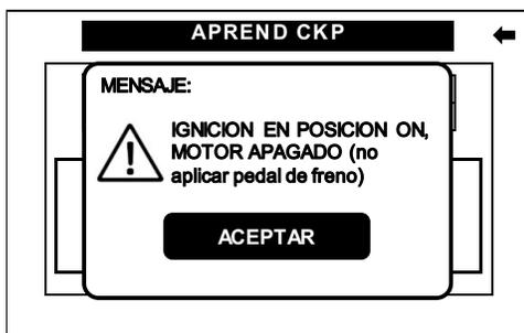
Primero coloque el conmutador de encendido en la posición de ON con motor apagado (**KOEO**), sin pisar el pedal del freno.
