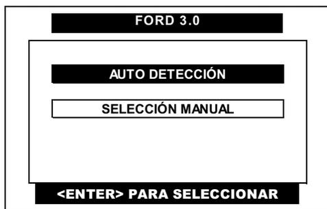
Del menú de FORD 3.0, pulse en la pantalla del CJ BT la opción de **AUTO DETECCIÓN** o presione la tecla <ENTER> para iniciar la función.
