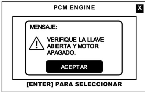
Al seleccionar la función de ACTUADORES, el CJ BT desplegará una advertencia, donde se indica que la prueba solo se puede realizar con el conmutador de encendido en la posición de ON y el motor apagado.
