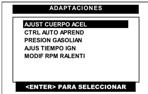
Pulse en la pantalla del CJ BT la opción **AJUST CUERPO ACEL** o selecciónela por medio de las teclas <ARRIBA> o <ABAJO> y presione la tecla <ENTER>.
