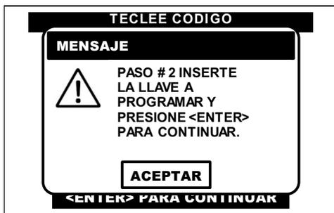
Como contamos con una llave que se quiere programar ya puesta en el **conmutador de encendido**, solo presionamos la tecla <ENTER> para continuar.
