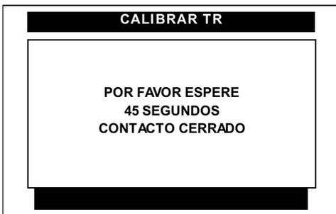
Para poder **terminar** con el **aprendizaje**, el CJ BT solicita que el conmutador de encendido este en la posición de **OFF** durante **45 segundos**.
