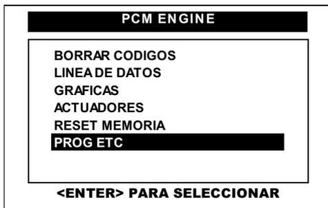
Del menú principal del sistema de **PCM** o **MOTOR** y con el conmutador de encendido en la posición de **ON** y el motor apagado (KOEO), pulse en la pantalla del CJ BT la opción **PROG ETC** o selecciónela por medio de las teclas <ARRIBA> o <ABAJO> y presione la tecla <ENTER>.
