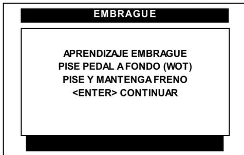
Pise a fondo el pedal del **acelerador (WOT)** el motor se va a mantener en promedio en **3000** rpm's, manténgalo toda la prueba o hasta que el CJ BT indique lo contrario.
