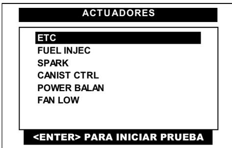
Pulse en la pantalla del CJ BT la opción del **actuador deseado** o selecciónela por medio de las teclas <ARRIBA> o <ABAJO> y presione la tecla <ENTER>.
