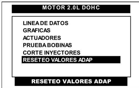
Del menú principal del sistema de motor pulse en la pantalla del CJ BT la opción **RESETEO VALORES ADAP** o selecciónela por medio de las teclas <ARRIBA> o <ABAJO> y presione la tecla <ENTER>.
