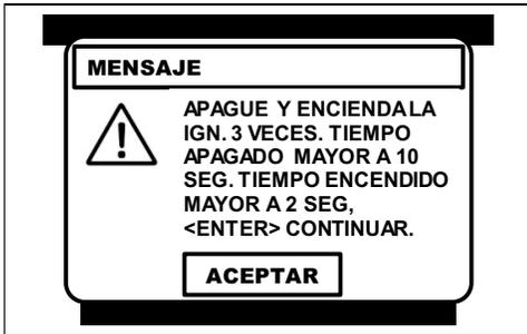
Como parte del procedimiento, el CJ BT solicita que se gire el conmutador de encendido a la posición de **OFF** y posteriormente a la posición de **ON tres veces**.
