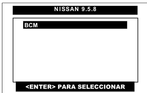
Pulse en la pantalla del CJ BT el sistema de **BCM** o selecciónelo por medio de las teclas <ARRIBA> o <ABAJO> y presione la tecla <ENTER>.
