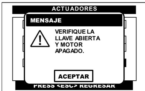
Al seleccionar el **ACTUADOR**, el CJ BT despliega una advertencia, donde se indica que la prueba solo se puede realizar con el conmutador de encendido en la posición de ON y el motor apagado (**KOEO**).
