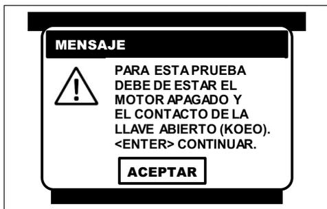
Para poder realizar esta función, verifique que el conmutador de encendido se encuentre en la posición de ON y el motor de encuentre APAGADO (**KOE0**) y presione la tecla <ENTER>.
