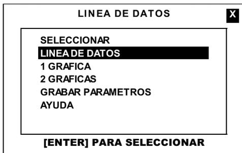
Una vez que haya seleccionado los parámetros requeridos, pulse la flecha de retorno o presione la tecla <ESC> del teclado y el CJ BT mostrará el menú principal de la línea de datos.
