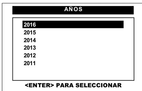
Pulse en la pantalla del CJ BT el **AÑO** del auto a diagnosticar, tomando en cuenta el 10° dígito del número de serie del vehículo o selecciónelo por medio de las teclas <ARRIBA> o <ABAJO> y presione la tecla <ENTER>.
