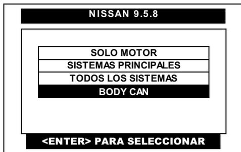
Del menú principal de **NISSAN 9.5.8**, pulse en la pantalla del CJ BT la opción **BODY CAN** o selecciónela por medio de las teclas <ARRIBA> o <ABAJO> y presione la tecla <ENTER>.
