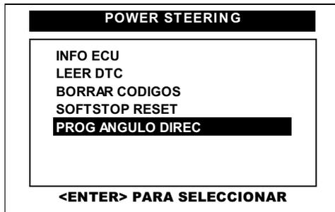
Del menú principal del sistema de la dirección asistida (**POWER STEERING**), pulse en la pantalla del CJ BT la opción **PROG ANGULO DIREC** o selecciónela por medio de las teclas <ARRIBA> o <ABAJO> y presione la tecla <ENTER>.
