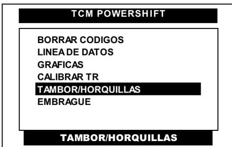
Pulse en la pantalla del CJ BT la opción **TAMBOR/HORQUILLAS** o selecciónela por medio de las teclas **<ARRIBA>** o **<ABAJO>** y presione la tecla **<ENTER>**.
