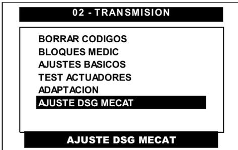
Pulse en la pantalla del CJ BT la función de **AJUSTE DSG MECATR** o selecciónela por medio de las teclas <ARRIBA> o <ABAJO> y presione la tecla <ENTER>.
