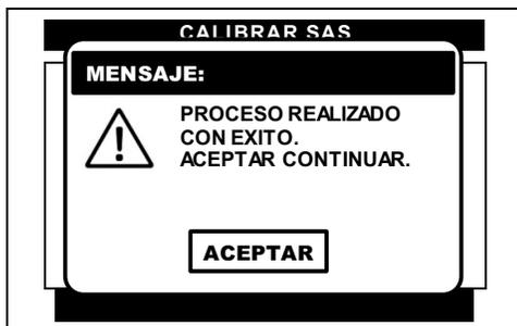
Al terminar el ajuste, el CJ BT desplegará en la pantalla la **confirmación** de que se realizó la función correctamente.
