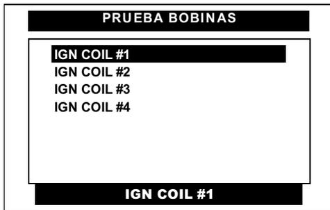
Pulse en la pantalla del CJ BT la **bobina** que se necesita **probar** o selecciónela por medio de las teclas <ARRIBA> o <ABAJO> y presione la tecla <ENTER>.
