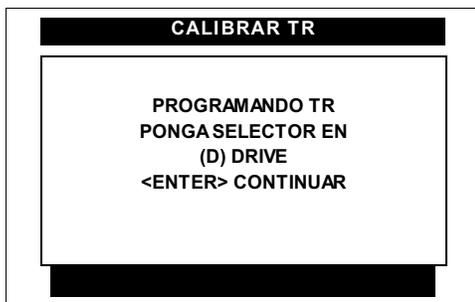
Coloque la palanca en la posición de **DRIVE** y presione la tecla **<ENTER>** para que aprenda la posición.
