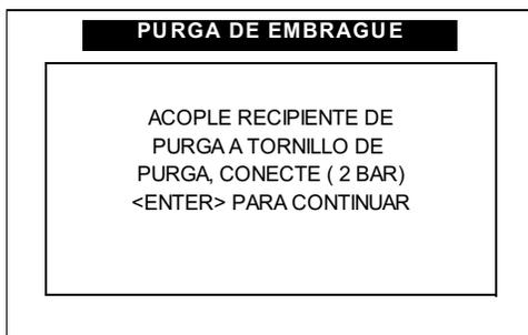
Este indica que se puede realizar el purgado del sistema, acoplado un recipiente de purga y abriendo el tornillo de purga.
