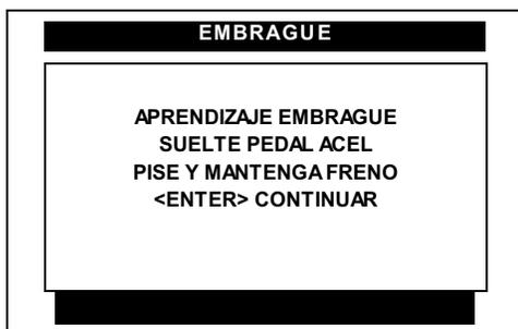
Suelte el pedal del acelerador y mantenga pisado el pedal del freno.
