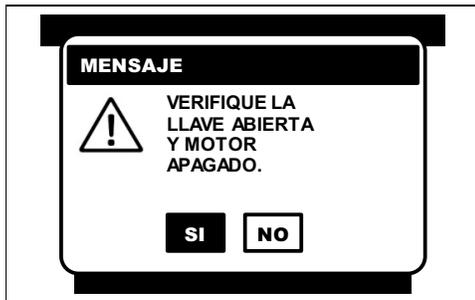
Al seleccionar esta función, el CJ BT despliega un mensaje donde se indica que la prueba solo se puede realizar con el conmutador de encendido en la posición de ON y el motor apagado (**KOEO**).
