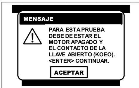
Para continuar, verifique que el conmutador de encendido se encuentre en la posición de ON y el motor de encuentre APAGADO (**KOE0**), por medio de las teclas <ARRIBA> o <ABAJO> seleccione la opción de SI y presione la tecla <ENTER>.
