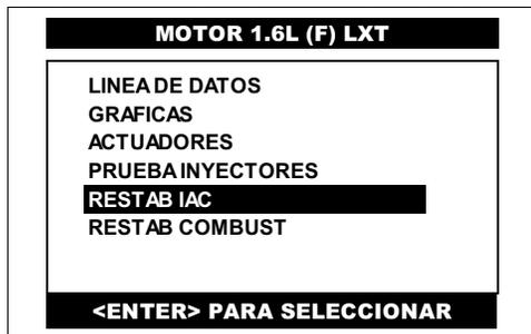
Del menú principal del sistema de motor y con el motor en ralentí, pulse en la pantalla del CJ BT la opción **RESTAB IAC** o selecciónela por medio de las teclas <ARRIBA> o <ABAJO> y presione la tecla <ENTER>.
