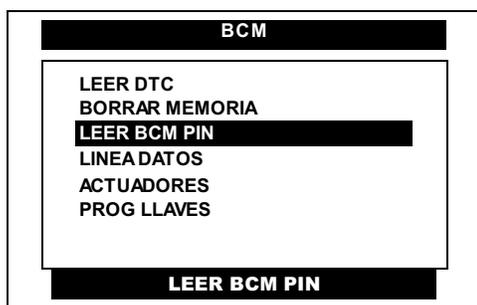
Pulse en la pantalla del CJ BT la opción **LEER BCM PIN** o selecciónela por medio de las teclas <ARRIBA> o <ABAJO> y presione la tecla <ENTER >.
