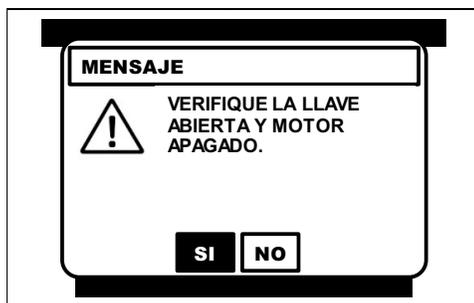
Verifique que el conmutador de encendido se encuentre en la posición de ON y el motor se encuentre apagado (**KOEO**). Por medio de las flechas <IZQUIERDA> O <DERECHA> seleccione la opción de **SI** y presione la tecla <ENTER>.
