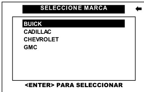
Pulse en la pantalla del CJ BT la **MARCA** a diagnosticar o selecciónela por medio de las teclas <ARRIBA> o <ABAJO> y presione la tecla <ENTER>.
