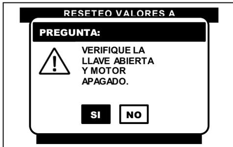
Al seleccionar la función de RESETEO VALORES ADAP, el CJ BT despliega una advertencia, donde se indica que la prueba solo se puede realizar con el conmutador de encendido en la posición de ON y el motor apagado (**KOEO**).
