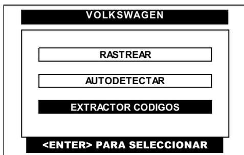
Pulse en la pantalla del CJ BT la opción de **EXTRACTOR CODIGOS** o selecciónela por medio de las teclas <ARRIBA> o <ABAJO> y presione la tecla <ENTER>.
